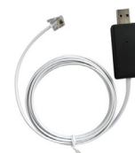
převodník PRE-USB (pro komunikaci s PC)
