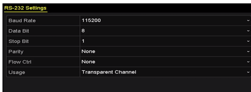
Obrázek 9–8 Nastavení připojení RS-232
