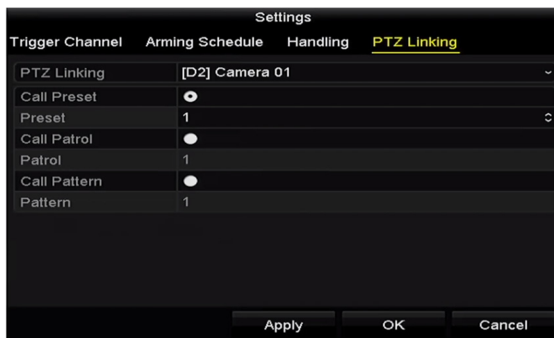
Obrázek 9–17 Nastavení propojení PTZ
