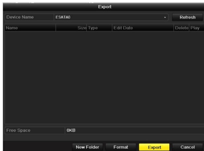
Obr. 7.17 Export při normálním vyhledávání videa s použitím eSATA HDD
