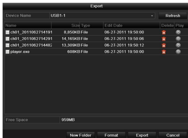
Obr. 7.30 Kontrola výsledku exportu video klipů pomocí USB Flash
