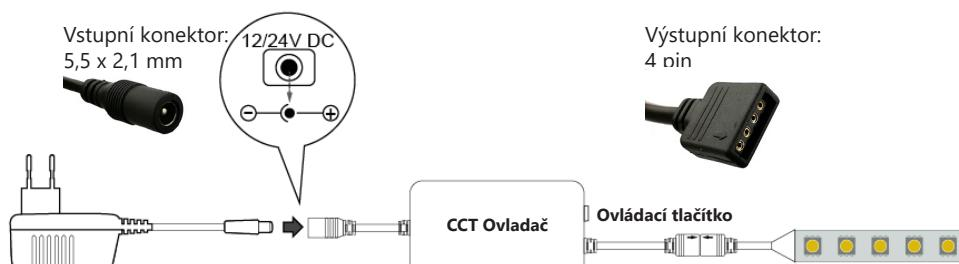
**Napájecí napětí ovladače je 12/24V DC, nikdy nepřipojujte přímo do sítě 230V AC!**
